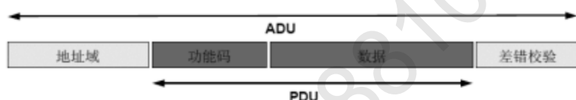
图 C.1 Modbus 通用帧结构
